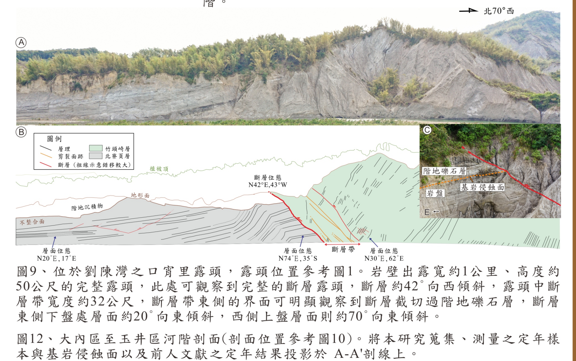
圖9、位於劉陳灣之口宵里露頭，露頭位置參考圖1。岩壁出露寬約1公里、高度約50公尺的完整露頭，此處可觀察到完整的斷層露頭，斷層約42°向西傾斜，高度中斷層帶寬度約32公尺，斷層帶東側的界面可明顯觀察到斷層切割階地礫石層，斷層東側下盤處層面約20°向東傾斜，西側上盤層面則約70°向東傾斜。
