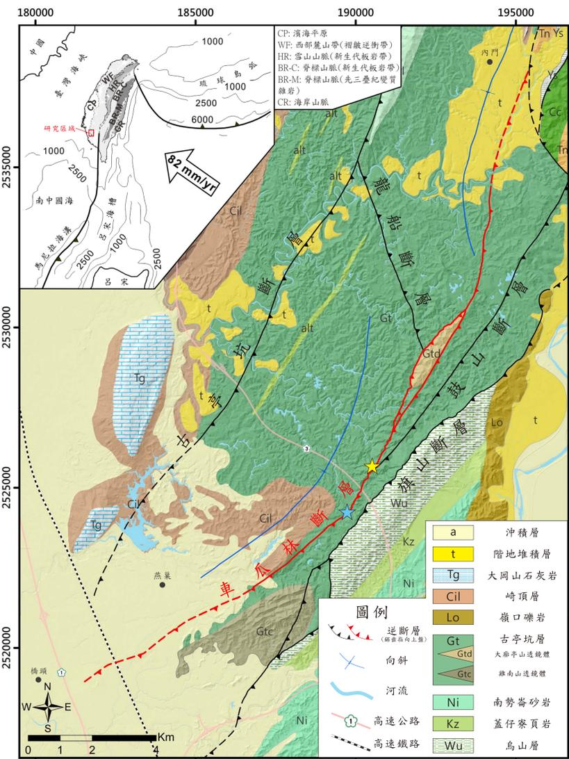
圖一、車瓜林斷層區域地質圖。紅色斷層跡突顯車瓜林斷層，黃色星號為採樣露頭點，藍色星號為岩心鑽取點。(改繪自地調所旗山圖幅[2013]；車瓜林斷層跡對彙與林啟文[2021])
