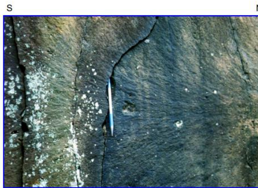
圖 4.11 第一組節理面上之羽毛狀條紋，其羽狀裂形長軸為水平南北方向(調查點：P17)。
