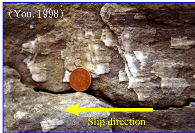
圖 4.12 第一組節理因剪切滑動而留下的擦痕面 (slickenside), 其擦痕滑動方向為水平右移的現象(調查點: P07)。
